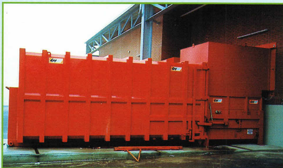
Stationært komprimeringsanlæg med væg tilsluttet tragt
