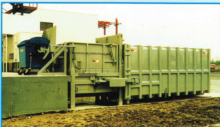
Stationært komprimeringsanlæg med tømningssanordning monteret på rampe
