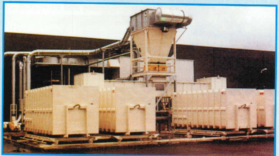
Stationær komprimeringsanlæg STV monteret på forskydeligt underlag og under udsuningsanlæg.
