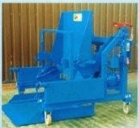
Transportabelt anlæg til 1100 liters beholder med indbygget vægt.
